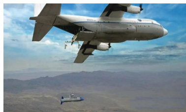
图2 美军 C-130 运输机回收“小精灵”无人机 [22]
