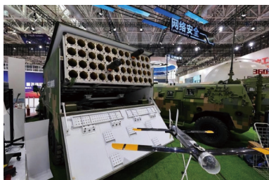
图 12 中国电子科技集团陆空无人机蜂群系统 [32]
