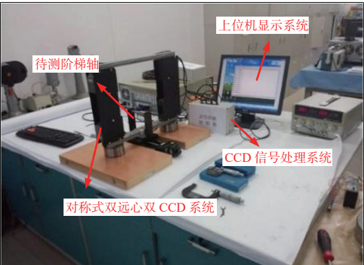
图 7 包含双远心系统的大型阶梯轴直径测量系统示意图 Fig. 7 Diagram of large step shaft diameter measurement system with dual telecentric system
