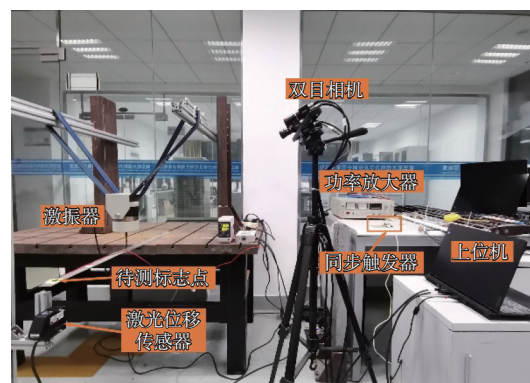
图9 双目视觉测量系统硬件组成
