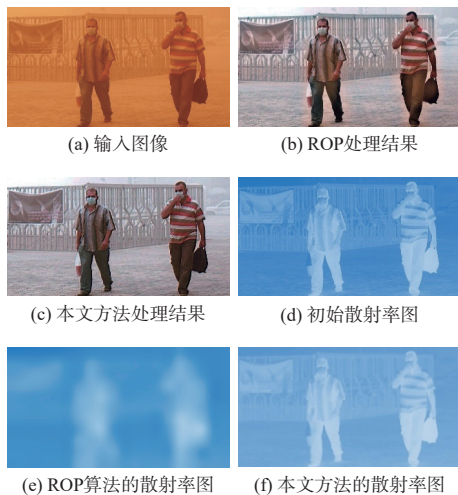
图 5 散射率图计算优化
