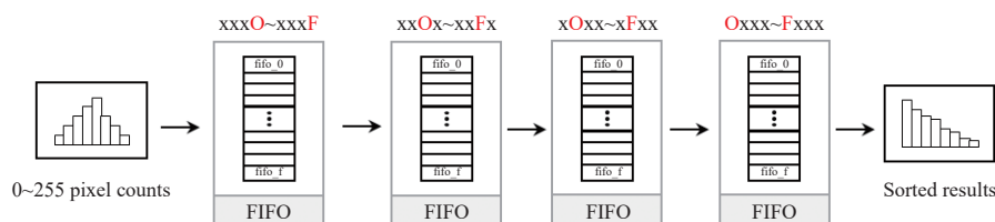
图 9 基于 FIFO 实现的基数排序法
