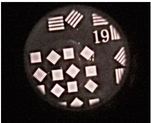
(c) 工作距离 1.9 mm 分辨率板图像
