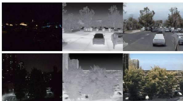
图 16 无人机飞行探测在夜间的红外转彩色可见光效果
