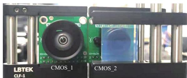
图 9 双目 CMOS 图像传感器激光告警实物图
