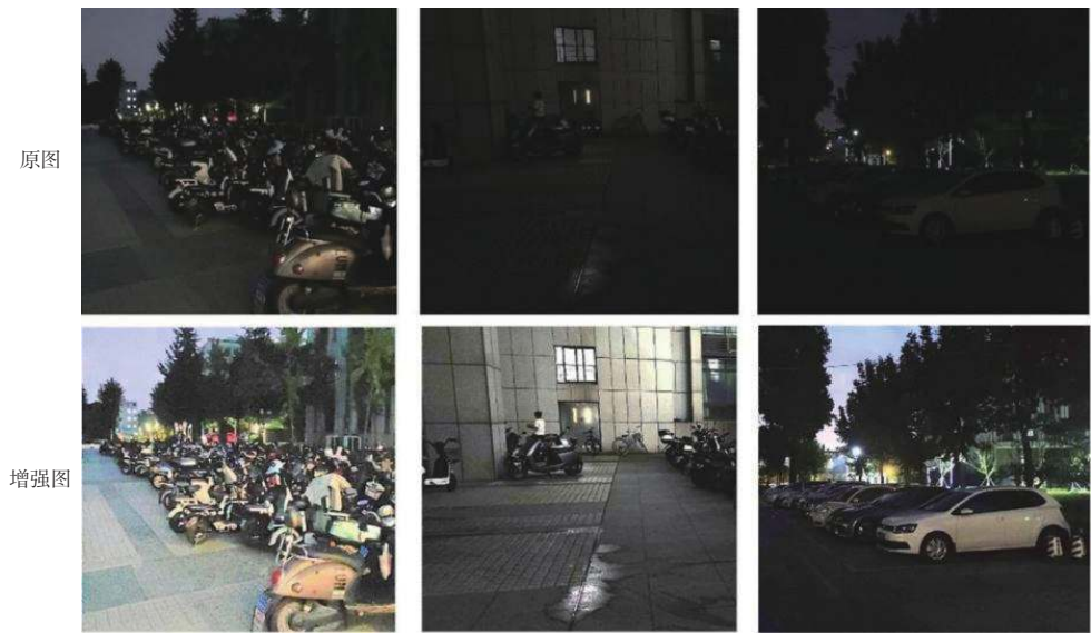
图 10 相机拍摄的微光图增强效果
