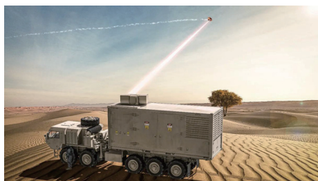
图 10 洛·马公司设计的 300 kW 级 HEL TVD 样机
