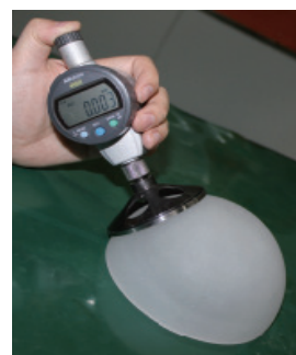
(d) 尖晶石超半球整流罩矢高差测量
