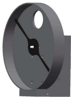
图 2 透射式能见度仪校准装置示意图 Fig. 2 Schematic diagram of transmissometer calibration device
