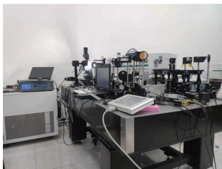
图5 双波长激光损伤阈值测试装置
