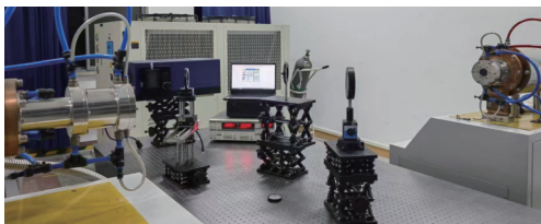
图 2 高温状态下材料法向发射率测量装置实物图
