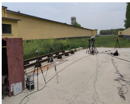
图 3 枪口焰烟光学特性测试现场
